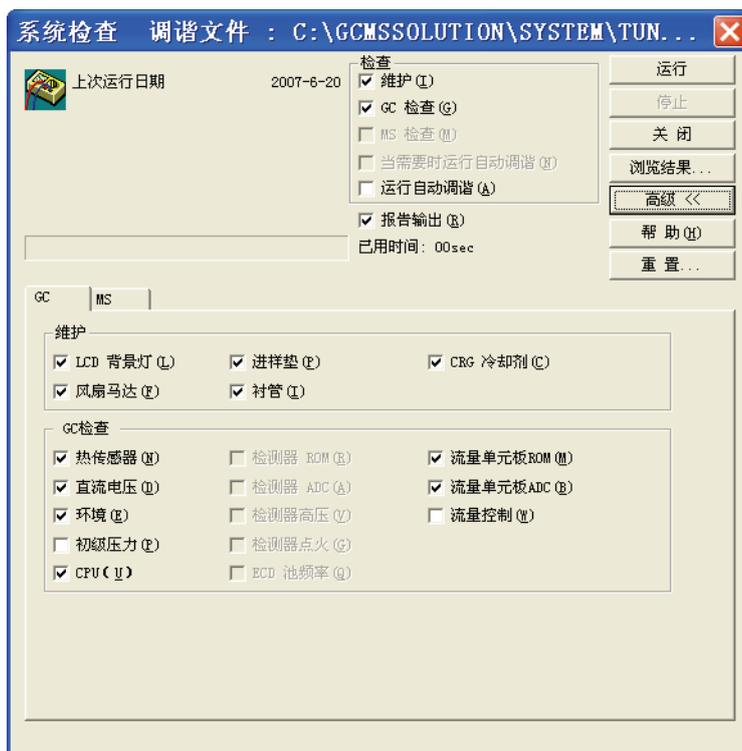
图 2.37 系统检查 GC 高级参数标签
