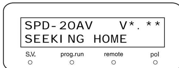
⑦ 波长准确度检查需要大约 20 秒（使用水银灯的 254nm 发射谱线和 D2（氙）灯的 656nm 发射谱线。）
